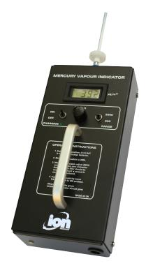
MVI - Portable mercury vapour indicator
